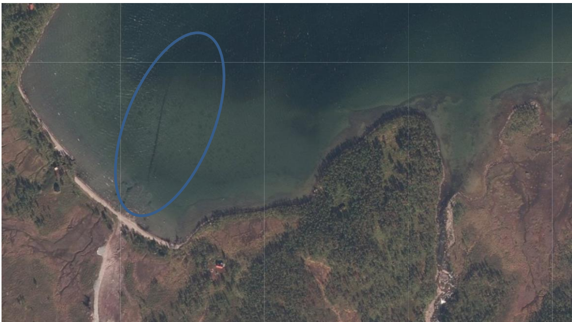
Figur 3 Oversikt over vannuttak og elveutløp fra Storvatnet. Vannuttaksledning er synlig ca. 150 meter ut fra vannkanten (markert med blå ellipse.). Kartkilde: NVE Atlas.
